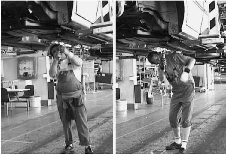
*Abb. 7: Lang andauernde Überkopfarbeit beim manuellen Verschrauben des Hitzschildes*
