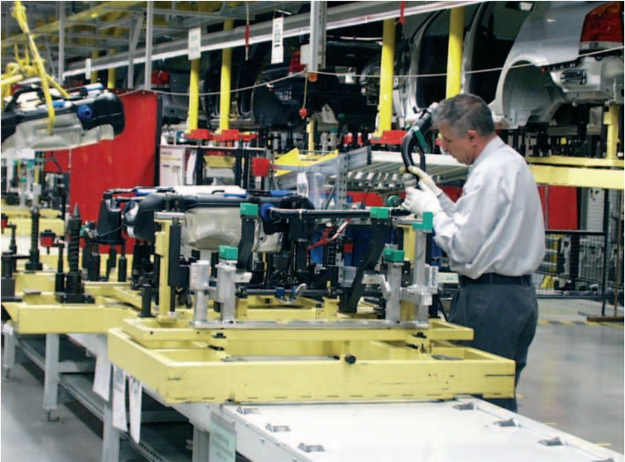
*Abb. 9: Vormontage von Kraftstofftank und -leitungen auf Leitungsträger*
