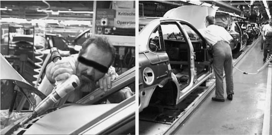
*Abb. 3: Körperhaltungen beim Betätigen des Schraubers mit der rechten (Bild links) und der linken Hand (Bild rechts)*
