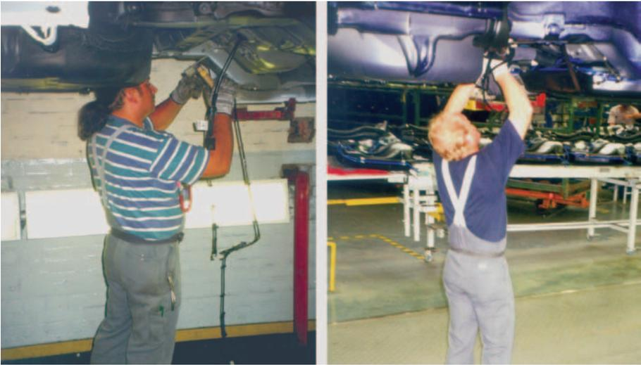
*Abb. 10: Verlegen der Bremsleitungen und manuelles Festschrauben des Tanks*
